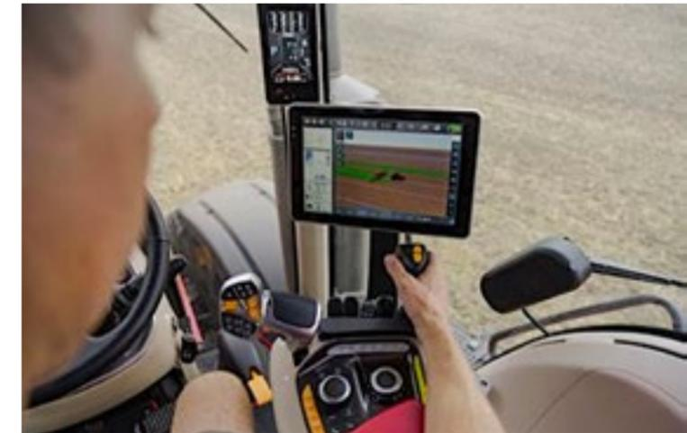
lità ottimale anche nelle giornate di massima intensità luminosa; del sistema operativo AFS Vision Pro, di facile utilizzo e configurabile in base alle singole esigenze grazie anche alla presenza di tasti di scelta rapida preprogrammati che permettono di eseguire aggiustamenti sul momento, e del ricevitore satellitare AFS Vector Pro che offre diversi livelli di precisione.
