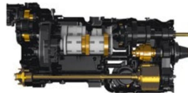
Una versione del cambio PowerDrive da 21 rapporti in avanti e 5 in retro (con velocità di 40 e 50 chilometri orari a regime motore ridotto) è invece l'unica trasmissione disponibile sul Magnum 400, proposto, al pari dei modelli Magnum 340 e 380, sia in configurazione gommata sia con allestimento con cingoli posteriori Rowtrac.
